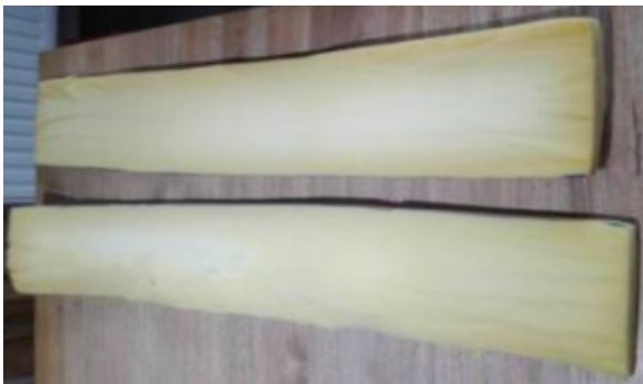
Figuur 3: De gebruikte mousserepen ( l = 90 cm, b = 14 cm, d = 2 cm)
