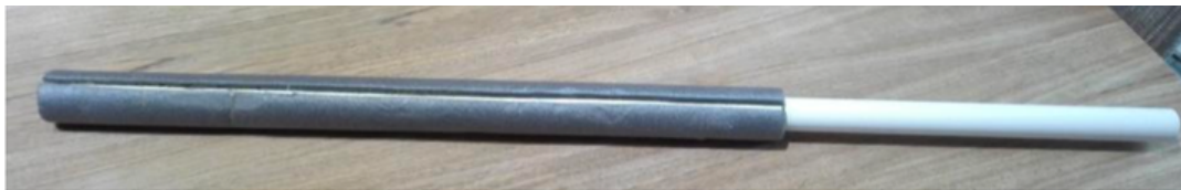
Figuur 2: PVC-Buis van 1 m met 70 cm buisisolatie
